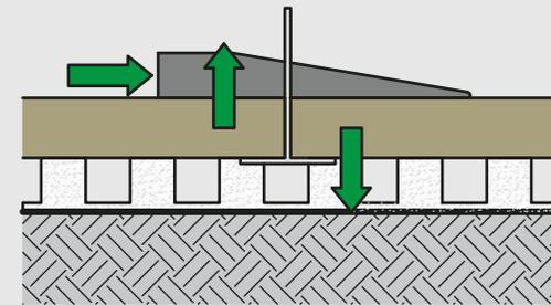
Il suit tous les mouvements des carreaux lors de la pose pour une parfaite planéité du support.
