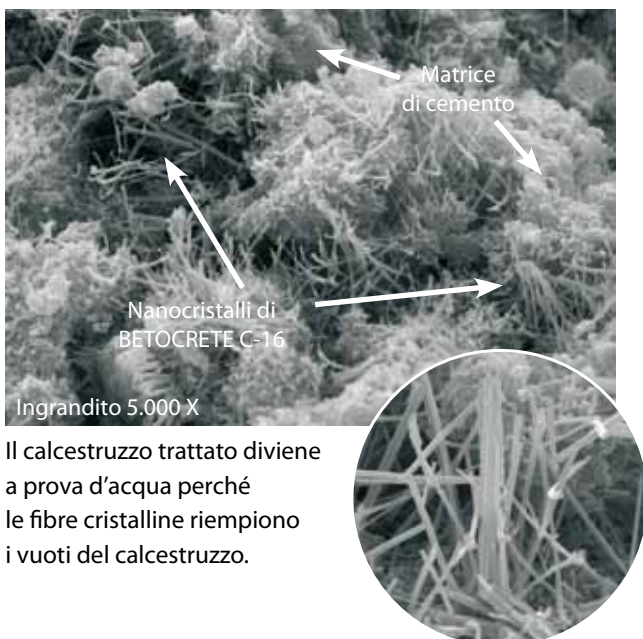
Foto ingrandita (10,000 X) dei nanocristalli di BETOCRETE-C16
