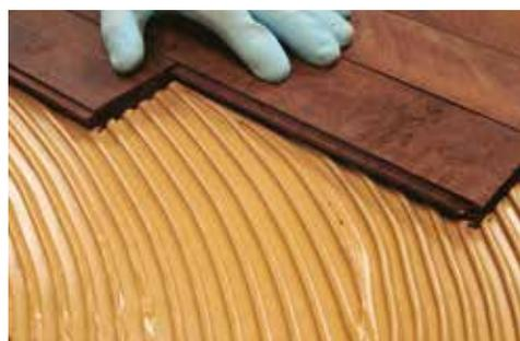
Adhesivo especial para la colocación de pavimentos de madera de cualquier tipo y tamaño sobre morteros de nivelación a base de cemento (humedad residual < 2%) y en anhidrita (humedad residual < 0,5%), incluso con calefacción. La colocación sobre morteros con humedad mayor de los valores indicados es posible con aplicación anterior de ASOWOOD-Primer.
